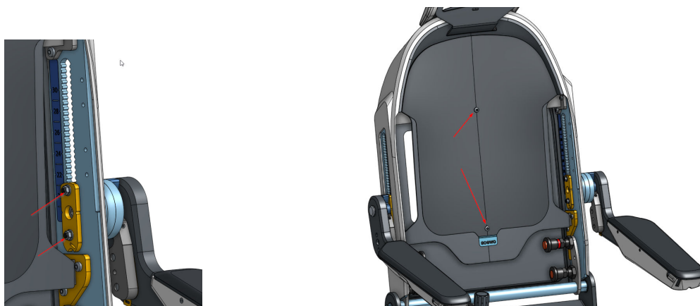
(a) Vis à desserrer pour démonter l'accoudoir
