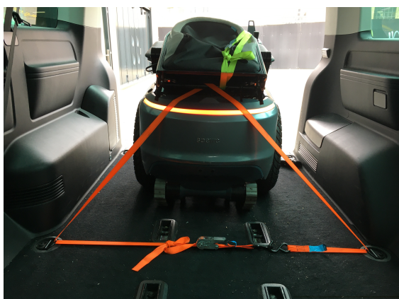
(c) Fixation du fauteuil roulant à l'arrière
