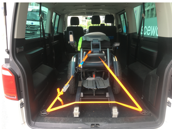
(a) Fixation du fauteuil roulant à l'avant
